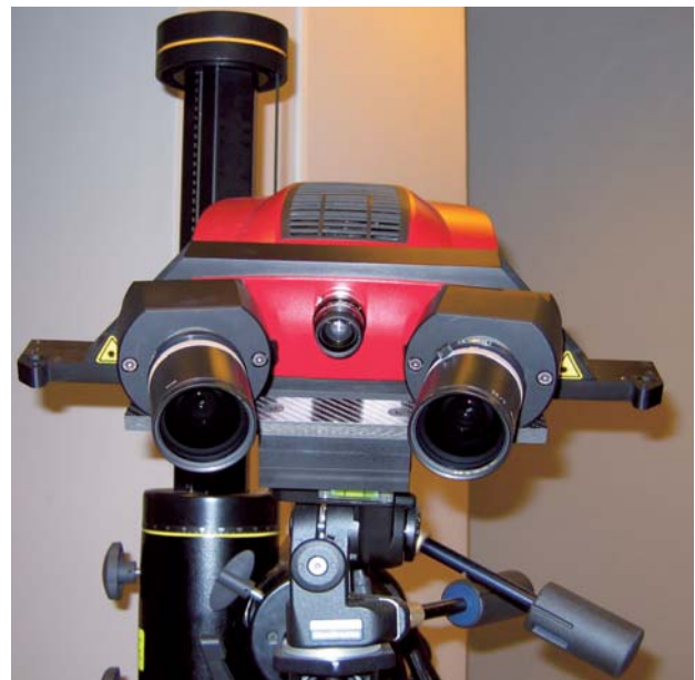
図1 非接触式三次元測定機の概観図 プロジェクタ（測定物へ縞模様の光を照射するために用いられる）と2個のCCDカメラにより物体を写真撮影します
