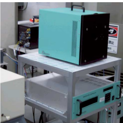
図1 赤外線測定システム 高精度に放射パワーの測定ができるFTIRとその基準光源としての黒体炉です
