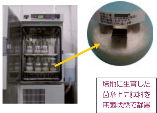
図5 木材耐朽性試験
