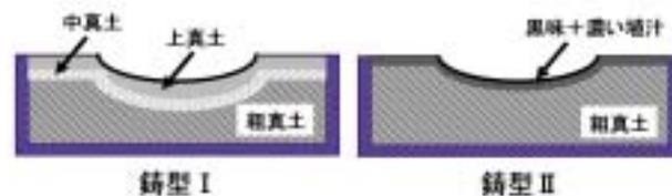
図2 鑄型断面構造のモデル
