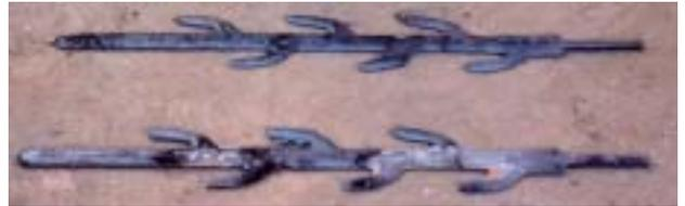
図6 最後に鑄込んだ復元刀。組織は白鑄鉄
