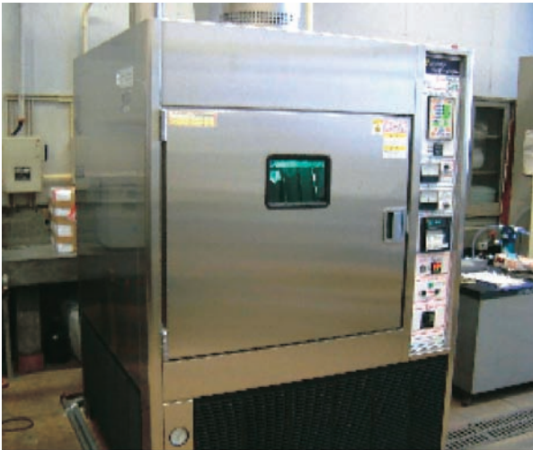
図1 サンシャインウェザーメーター 耐候性試験機のうち、古くから利用されていて、最も基本的な機種です
