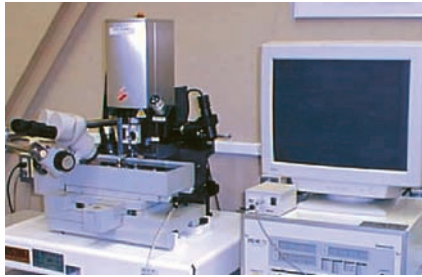
図1 マイクロ放電加工機 パソコンと同じくらいの放電加工機です。 \phi 5 \mu\text{m} 程度の穴加工ができます
