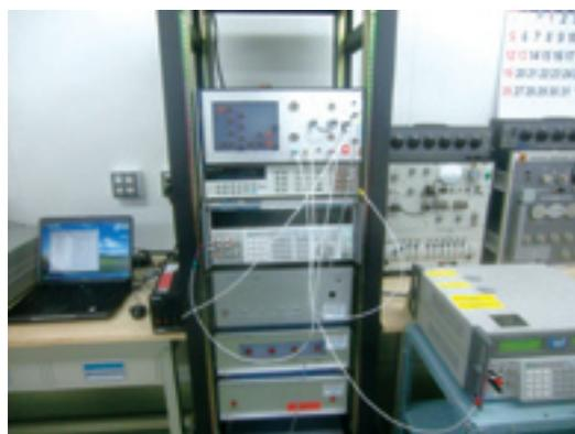
共同研究により開発した分圧器と自動評価システム
