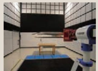
3m 法電波暗室
