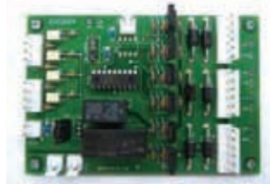
電源/安全制御基板
