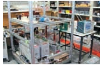
試作した雷インパルス発生装置
