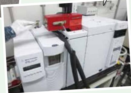
捕集したVOCはガスクロマトグラフ質量分析計を用いて分析します
