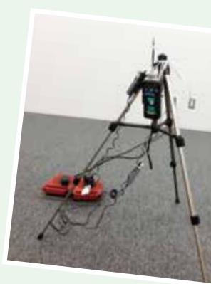
大気中のVOCを吸着管に捕集しています
