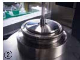
装置の全体像(上)とセンサー部(下) 溶液を下部センサーに設置し(①)、上部センサーで挟みこんで(②) 微小振動を加える
