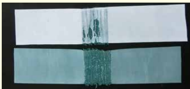
図2 異なるコーティング層の状態変化(200回摩耗後)
