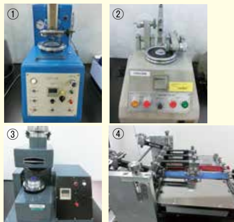
図3 各種摩耗試験機上から、ユニバーサル形、テーバ形、ユニホーム形下段 学振形(平面台)
