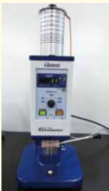
図1 ガーレ形通気性試験機(左側)と試料の取り付け状態(右側)
