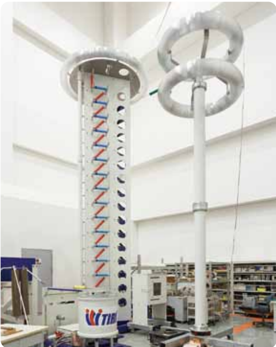
雷インパルス電圧発生装置
