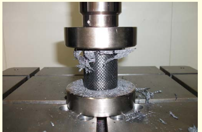
図3 万能試験機による性能試験(CFRPパイプの圧縮試験)
