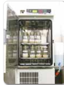
腐朽菌が生育した培地で木材試験片を12週間連続して腐らせる様子
