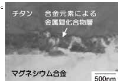
図2 チタンとZK60マグネシウム合金の接合界面のTEMによる明視野像
