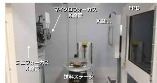
図1 大型X線CT装置の内部
