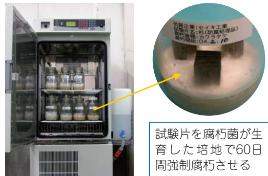
図2 木材耐朽性試験の様子
