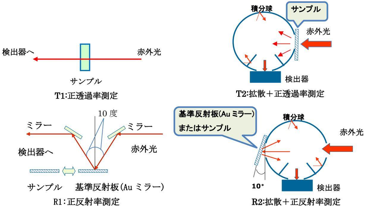
※反射率測定は市販金ミラーを基準反射板に使用します。
