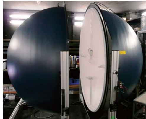
図4 LED用球形光束計（平成21年度導入）
