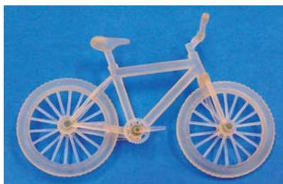
図1 インクジェット式三次元造形装置による試作品
