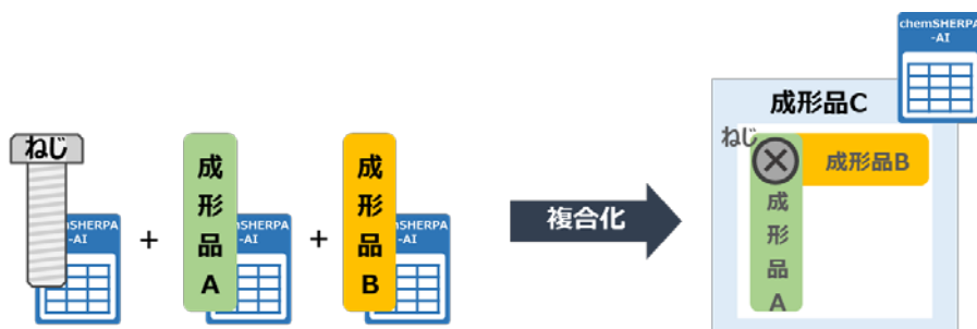
図 2-1 複合化 1 : 成形品 A と B を調達し、ねじで結合した成形品 C を製造するケース
