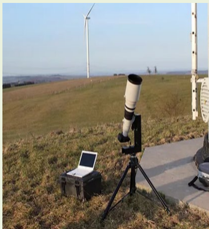
ブレード外観点検
