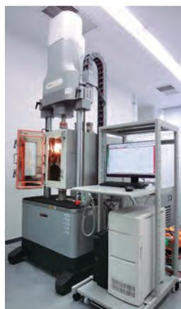
高温・低温環境下における疲労試験を実施し、繊維強化複合材料などの評価に活用できる装置です。引張・圧縮負荷、ねじり負荷、およびこれらの組み合わせ負荷が可能であり、疲労破壊に至るまでの繰り返し数のほか、指定した繰り返し数に達した際の荷重やストローク、トルク、角度、および温度を出力できます。
