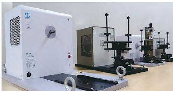
モーターの性能測定に活用できる装置です。モーターに実負荷を与え、モーターの機械的出力であるトルク[N・m]および回転速度[r/min]を測定します。さらに、電気的入力である電圧[V]、電流[A]、電力[W]を電力計で測定し、モーターの効率[%]を自動的に計算します。5種類のトルク測定器の中から、適切な測定器を選択できます。
