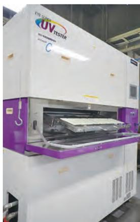
屋内外で材料が劣化する因子となる光などを試験機内で人工的に再現し、製品の長期耐久性を短期間で評価できる装置です。樹脂材料、木材、塗装品や印刷物など、さまざまな材料での試験が可能です。有効試験面積が大きいので、大型の試験品（厚みは最大で40 mm、重量5kgまで）にも対応可能です。
