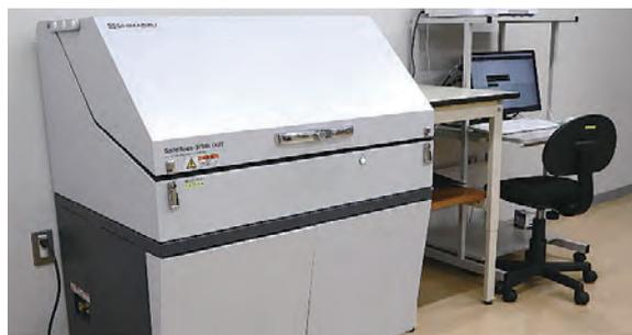
240 nmから2600 nm（紫外領域から近赤外領域）の透過率・吸光度・反射率を測定できる装置です。主に、板ガラスの透過率・反射率や塗膜の日射反射率、建築窓ガラス用フィルム透過率、反射・透過による測色、繊維の紫外線遮蔽率（UPF）などの測定に用いられるほか、光透過の膜厚測定、全反射・拡散反射の測定も可能です。
