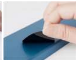
測定対象部からコンタミを転写させる
