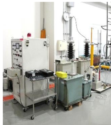
図1 東京変圧器製耐電圧試験器
