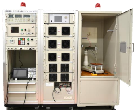
図1 装置外観 左・中央)測定器・制御部 右)シールドボックス
