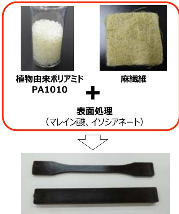
図1 作製したポリアミド複合材料の試験片
