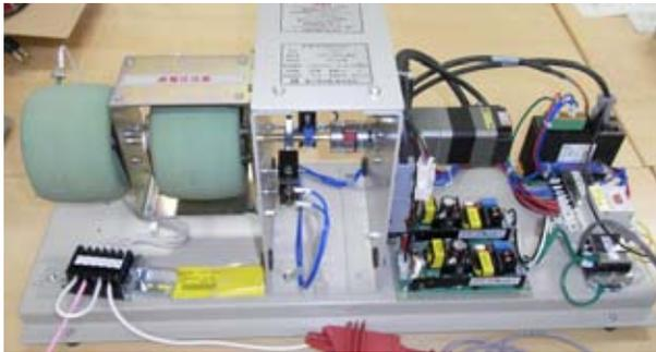
図1 可変抵抗器のモータ制御装置
