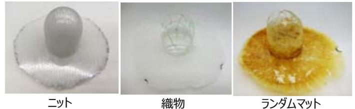
図3 各種基材複合材料の賦形性評価 (30 mm深絞り)
