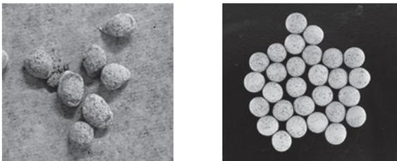
図1. リン吸着用ブラウン管パネルガラス焼結体の概観
