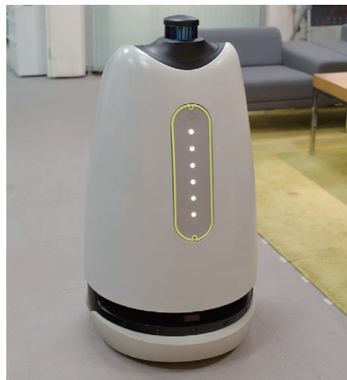
次世代型自律移動案内ロボット「Libra」 頭部にタッチパネル機能を備えた液晶パネルを搭載し、情報提供を行います *2 。先導案内を行い、音声や画面タッチによってロボットを操作できます。ロボットのデザインは意匠登録出願中です。
