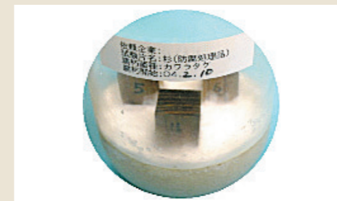
木材腐朽試験 腐朽菌が生育した培地で木材試験片を12週間連続して腐らせる
