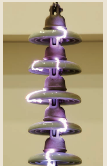
高電圧試験例 (がいしのフラッシュオーバー電圧試験)
