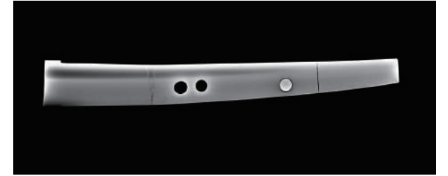
「継ぎ茎」のX線透過画像 溶接部分が黒い線として映し出されている。
