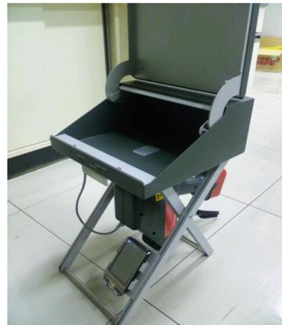
図 1. 専用架台に固定した HXRF の外観
