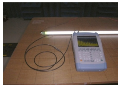
LED照明機器のノイズ探査 (エミッション測定)
