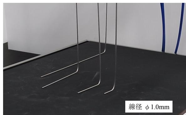
図1. 熱板への熱電対取付け状況
