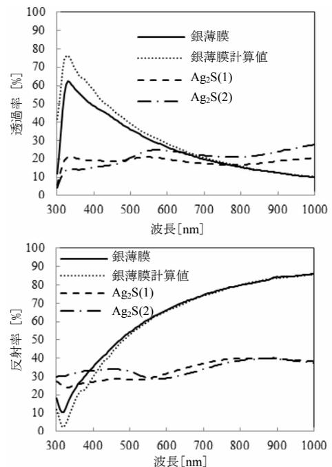
図1. 銀薄膜及び硫化銀薄膜の分光特性
