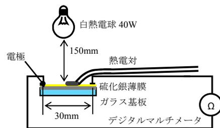
図2. 硫化銀の光電特性実験の模式図
