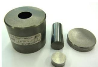
図2. 加圧に用いたペレッター ( $\phi 10$  mm)
