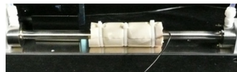
図5. 従来型測定セル (セル長約 30cm)
