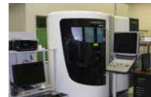
城南支所 レーザー型彫り装置
