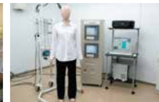
墨田支所・生活技術開発セクター サーマルマネキン
