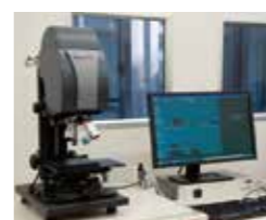
電子・機械グループ 三次元表面形状測定機 (走査型白色干渉計)
