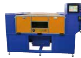
城東支所 ファイバーレーザー加工機
