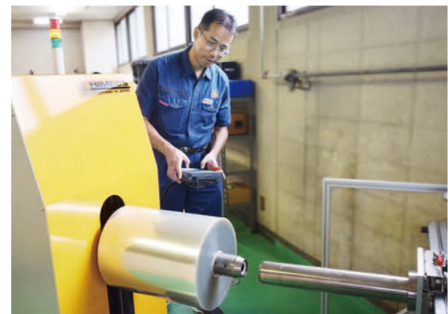
軸の先端にカメラが内蔵されており、生産設備の巻軸の位置を認識して位置を合わせる。原反自体の設置は人力で行う。
