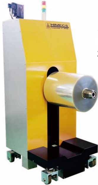
■ 小型全方位走行運搬ロボット 先端に原反を受ける軸があり、最大60kgの原反を運搬することが可能。
