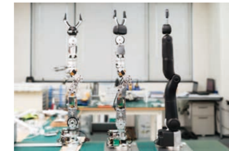
ロボットアームは6つの関節を持つ軽合金製腕部とグリップ一部から成る。電動車椅子上での使用を想定し、電源は電動車椅子のバッテリーを利用する。
