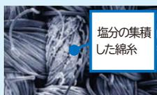
顕微鏡で拡大すると、ストライプの綿糸に塩分が集積して白化していたことが判明。
