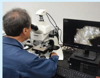
顕微鏡からモニターに映し出された繊維の画像を解析し、クレームの原因を突き止める。
