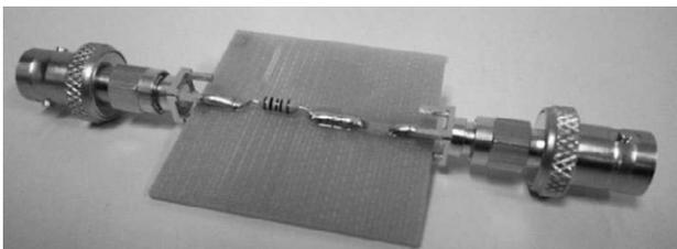
図7. 測定系に挿入した抵抗器
