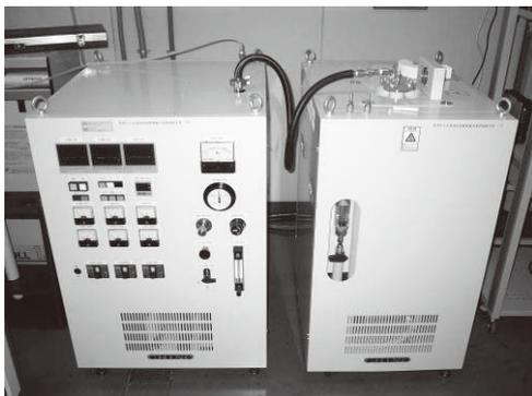
図2. 金属-炭素共晶点実現装置(右:電気炉)
