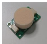
接触センサ (タッチエンス (株) POT-D-SN18X10CN)
