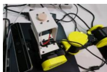
可視光+深度画像カメラ (Intel RealSense F200) と手先の一部
