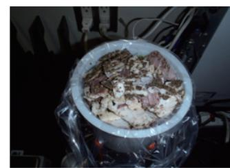
図 3. 泥付着状態での放射能測定
