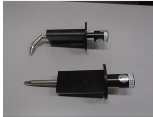
図5 関節型とストレート型テストフィンガ
