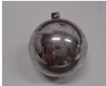
図6 衝撃試験用鋼球
