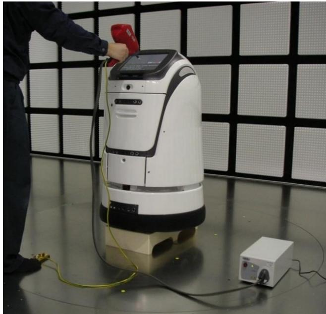
電気電子機器は、空気が乾燥した使用環境において、帯電した人体からの静電気放電（ESD）による電磁現象が発生したとき、その基本性能が阻害されず、動作を継続することが期待されます。
