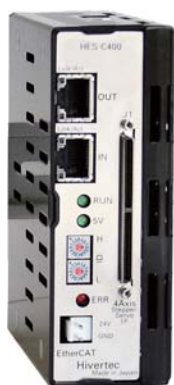
EtherCATモーションコントローラ HES-C400シリーズ
